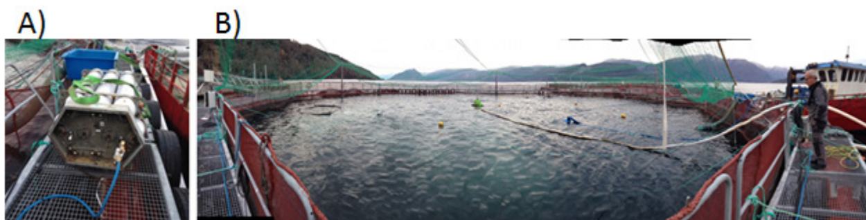
Figur 20: Forsøksoppsett. A) oksygenpakke på merdkanten. B) merd med blåser som indikerer optodeposisjonene.
