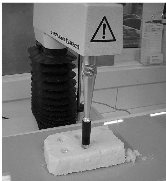
Figur 10: A) Oppsett for teksturmålinger som viser probe, samt plassering av prøven med fiskepudding. B) Plassering av målingene på fiskepuddingen.
