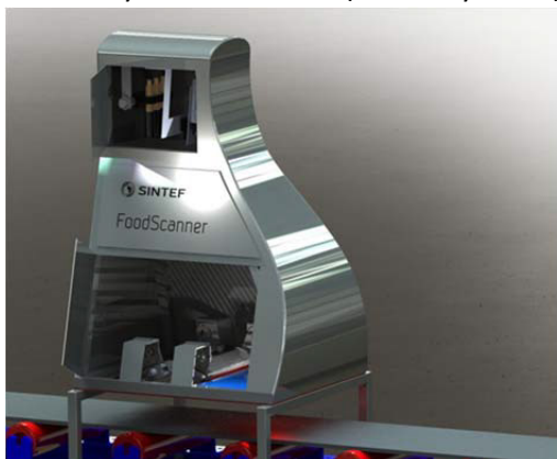
Figur 8 – Konsept for Food Scanner ombord på snurrevadfartøy (Foto: SINTEF Fiskeri og havbruk)
