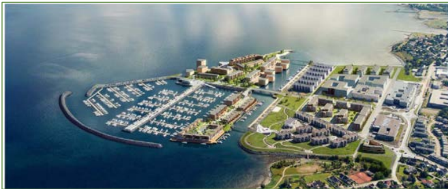
Figur 1: Grilstad Marina, Trondheim. Utbyggingen av Grilstad Marina startet for fullt i 2010 da stein fra den 2,5 kilometer lange Strindheimtunnelen ble brukt til å fylle opp sjøbunnen utenfor Grilstad fabrikker: Kilde: www.grilstadmarina.no og [5].
