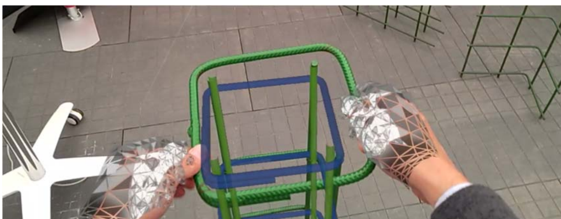
Figur 28: Demonstrasjon av hvordan AR kan brukes til å plassere armering i riktig posisjon
