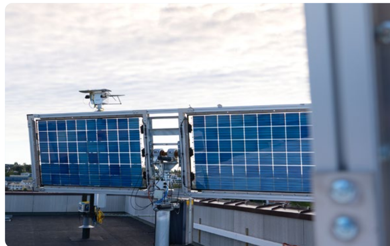
Dobbeltsidige solcellepanel som fanger sollys direkte og fra miljøet rundt. Solcellepanelene følger solens plassering på himmelen ved hjelp av en solfølger. Foto: Edvin Wiggen Dahl/SINTEF
