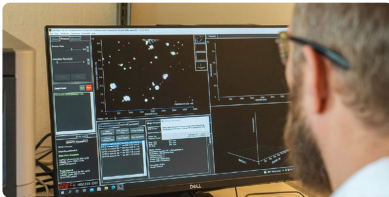
Forsker Andreas Åslund forsker på nanoteknologi for å forbedre legemiddellevering til pasienter. Her analyserer han størrelsen på nanopartikler med legemidler ved hjelp av Nanoparticle Tracking Analysis (NTA). Foto: Smidesang & Lyng/SINTEF
