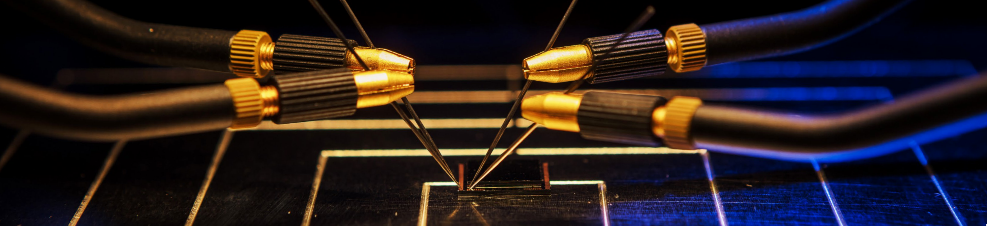
En silisiumstrålingssensor, som brukes til å påvise ioniserende partikler og lys. Foto: SINTEF/Werner Juvik
