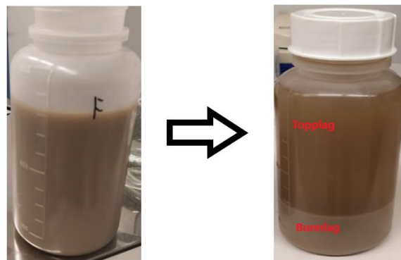
Figur 9: Visuell framstilling av sedimentering etter 48 timer
