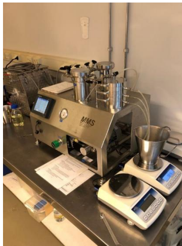
Figur 11: MMS Membrane Triple System (MMS) som ble benyttet ved nanofiltrering
