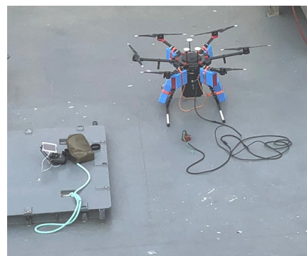
Bilde: Transceiver var festet til dronen sammen med batteri og omformer. Transducer hang i en 9 meter lang kabel fra den flyvende dronen og ble senket under vann.
