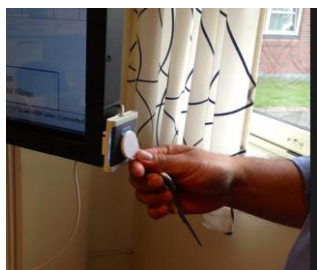
Figur 4: RFID-brikker kan benyttes for enkel pålogging og utvelgelse av informasjon basert på rettighet og roller til brukeren.
